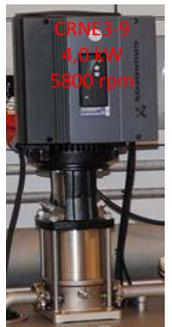
La CRE3-9 es una bomba pequeña que suele adaptarse para grandes velocidades y se monta con un motor E de 4kW que funciona a 5800 rpm: esta configuración ofrece el mismo rendimiento que una CRE5-36.
